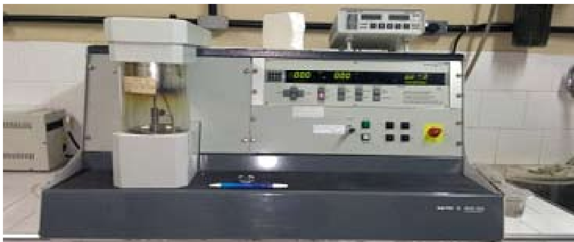
FIGURA 5: Aparelho metalizador para revestimento condutor das amostras para a análise via microscopia eletrônica de varredura.
